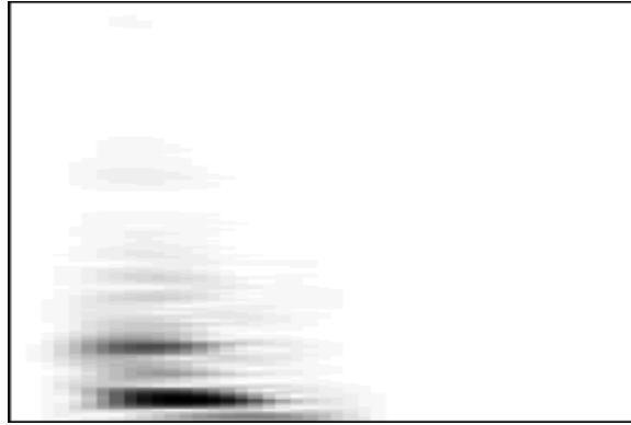
FIG. 16 – Spectrogramme du grain choisi pour la décomposition, d'une durée de 40 ms, pris entre 0 et 3000 Hz.
